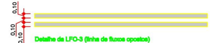
Detalhe da LFO-3 (linha de fluxos opostos) Manual Brasileiro de Sinalização de Tráfego - volume IV - página 14. Cor: AMARELA (10 YR 7,5/14).
